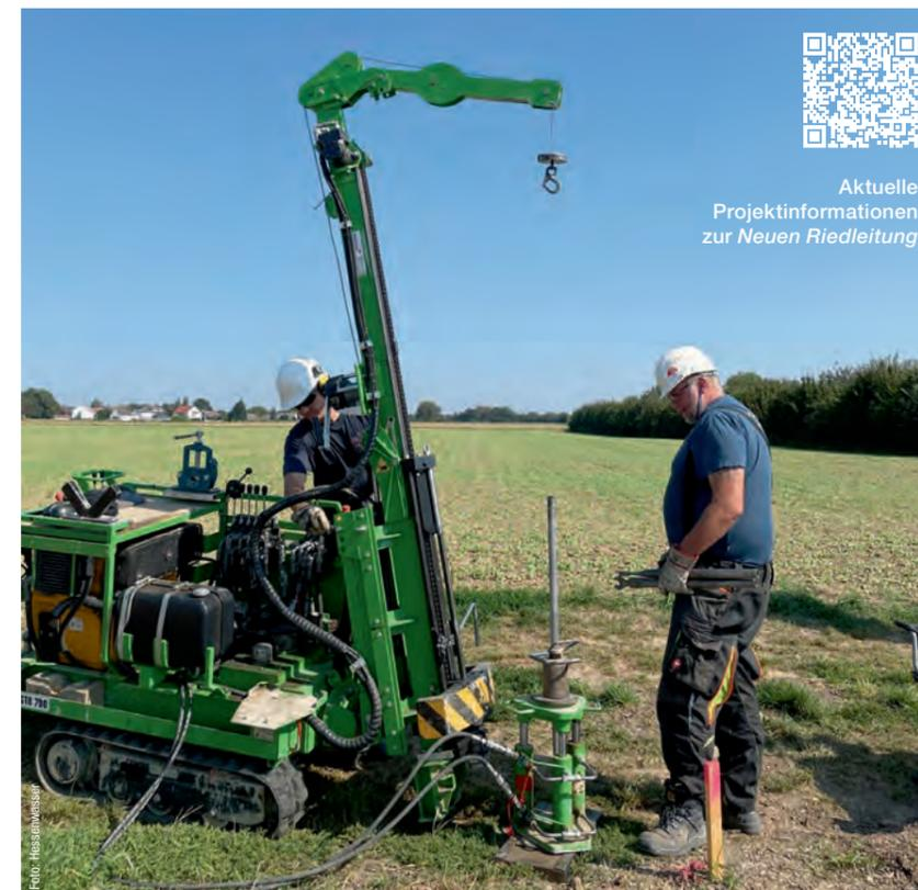
verfüllt und sind anschließend uneingeschränkt nutzbar. Baugrunduntersuchungen finden parallel zu den Planungsarbeiten statt, um frühzeitig mögliche bautechnische Probleme zu identifizieren und darauf reagieren zu können.
