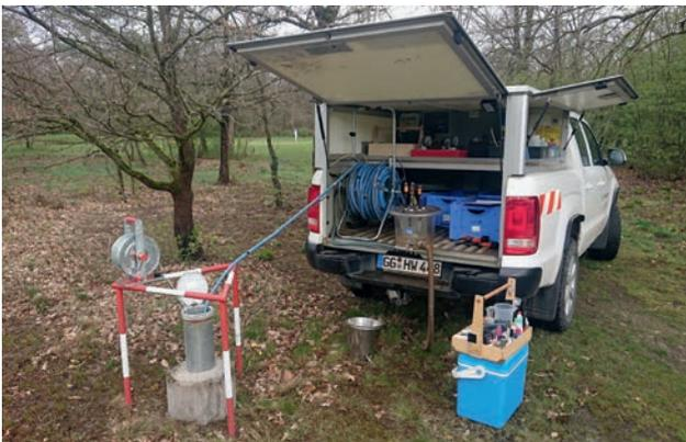
Mobiler Messwagen nimmt Proben des Grundwassers an Bahn 14
